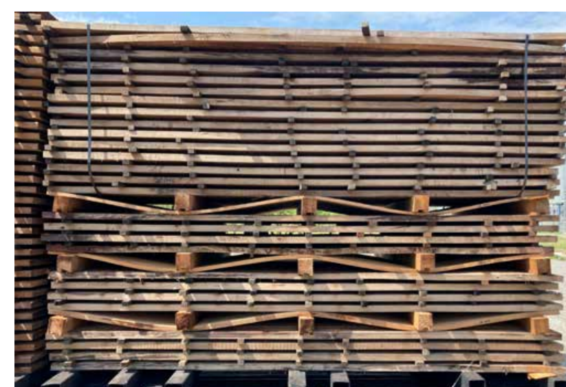
↑ Houten planken onder het eigen gewicht laten buigen in de stoomcabine
