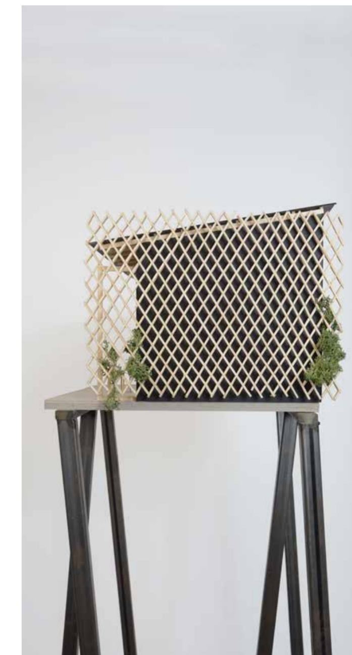
↑ De gevelbekleding komt tot stand door uitsparingen te frezen die op deze manier halfhouts verbindingen vormen
